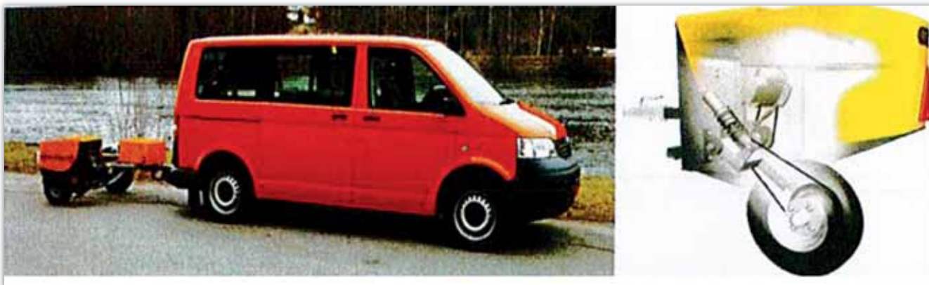
Rys. 1. Zestaw pomiarowy składający się z pojazdu ciągnącego i jednostki (przyczepki) pomiarowej oraz widok systemu hamowania jednostki pomiarowej ViaFriction
